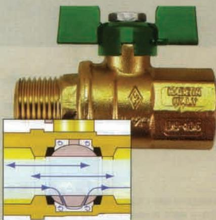
Благодаря использованию новой технологии TEA (Ternary Eco Alloy — тройной экологичный сплав) детали корпуса изделий не подвергаются в дальнейшем никелированию. На них вообще не нужно наносить какое-либо дополнительное защитное покрытие. Другими словами, в технологии производства изделий отсутствуют гальванические процессы, весьма вредные для окружающей среды. Кроме того, исключается попадание в воду никеля.
