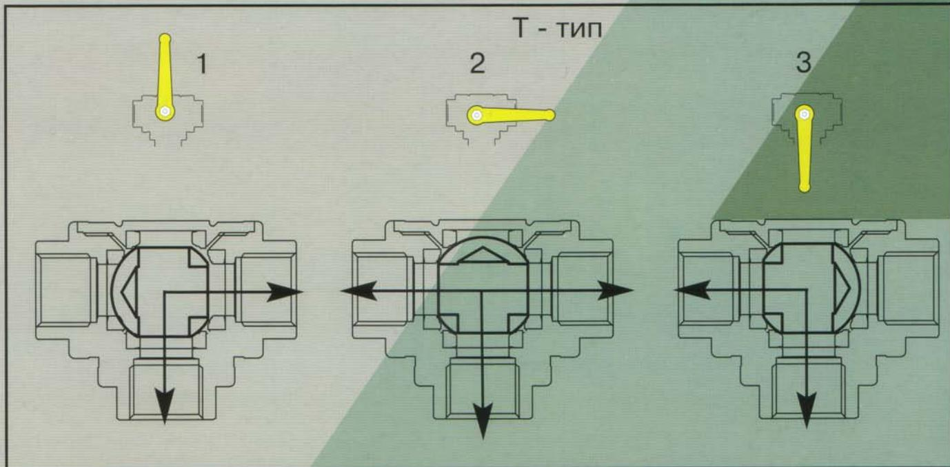
лия под газ и воду? Если говорить о корпусе кранов, то принципиальных отличий у них сегодня нет. Есть даже серия водозапорной арматуры, изготавливаемая в точно таких же по виду корпусах, что и газовая. Однако не все так просто. Следует иметь в виду, что корпус изделий под газ имеет конструкцию, отвечающую европейским требованиям газовой безопасности. Так, на него нанесена резьба увеличенной длины. Как следствие, увеличивается и полная длина, а также в целом массогабаритные характеристики крана.
