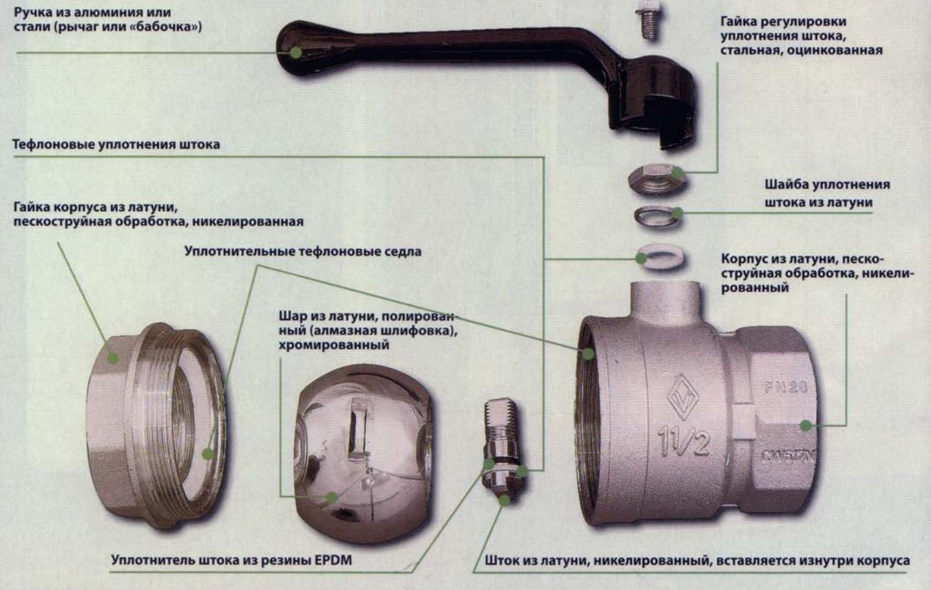
ные из фторпласта, практически не подвергаются износу при контакте с отшлифованной сферой. Открывают арматуру одним движением, поворачивая шток на четверть оборота.
